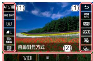
在拍攝或播放畫面上按下 按鈕進入速控畫面，在此畫面上您可以調整設定。選擇左右兩側的設定項目，以在下方顯示所選項目的設定選項。
